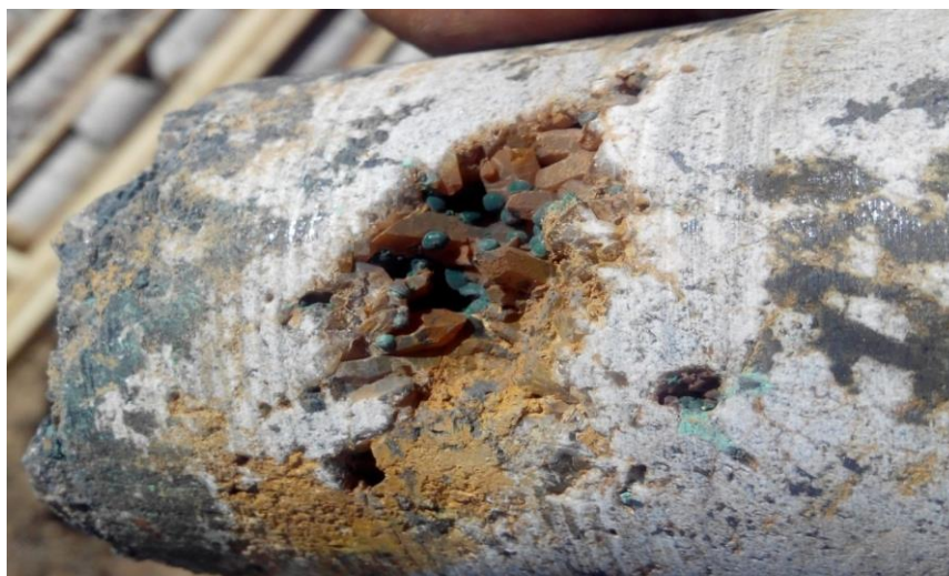
Рисунок 3- Почковидные агрегаты малахита в полости раскристаллизации кварца (АКЦ-6 гл. 52,3 м)
