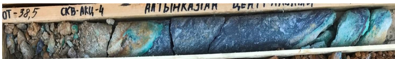
Рисунок 4- Пропласток мономинерального халькозина (Скв. АКЦ-4)
